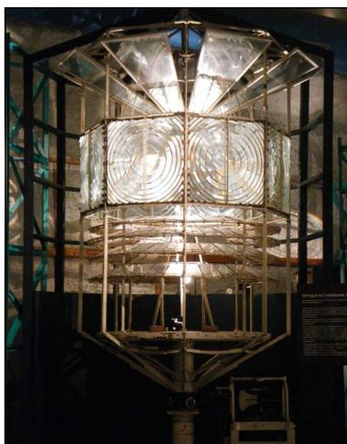
La mise en place de l'appareil lenticulaire à feux tournants d'Augustin Fresnel constitue une révolution technique à portée mondiale. Ce système d'éclairage, testé sur l'Arc de triomphe de Paris, est installé en présence de son concepteur, le 25 juillet 1823.
